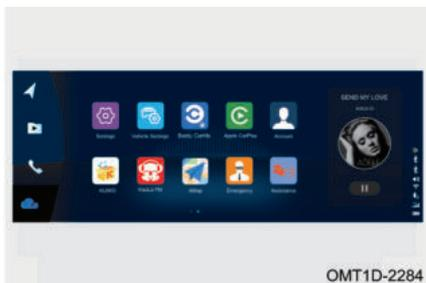
Система Cloudrive дает доступ к следующему меню: настройка, настройка систем автомобиля, Baidu Carlife, KuWo, Koala FM, Амар, вызов экстренных служб, вызов технической помощи и к другим приложениям.
