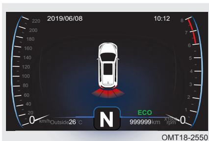
Экран системы помощи при движении задним ходом выводится на информационный дисплей после пуска двигателя и перевода рычага селектора в положение R.
