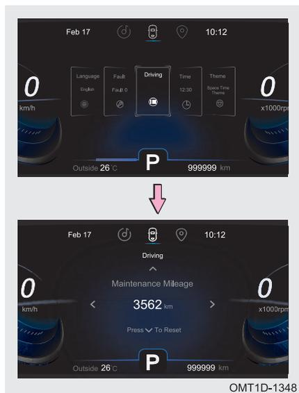
Шаг 1. При выведенном на дисплей экране настройки нажмите кнопку ◀ или ▶ на рулевом колесе, чтобы переключиться на экран информации о вождении автомобиля. Нажмите на нижнюю часть кнопки/коротко нажмите кнопку OK на рулевом колесе для отображения информации о вождении автомобиля.
