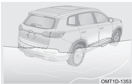
Автомобиль может получить серьезные повреждения, преодолевая водное препятствие, возникшее из-за сильного ливня и т. п. Если преодоление водного препятствия неизбежно, проверьте его глубину и двигайтесь медленно и осторожно.
