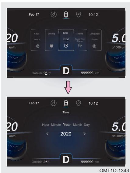
Шаг 1. При выведенном на дисплей экране настройки нажмите кнопку ◀ или ▶ на рулевом колесе, чтобы переключиться в режим установки времени. Нажмите на нижнюю часть кнопки/коротко нажмите кнопку OK на рулевом колесе для перехода на экран установки времени.
