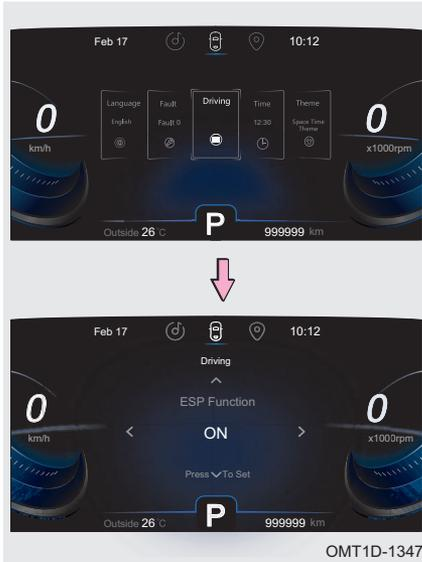
Шаг 1. При выведенном на дисплей экране настройки нажмите кнопку ◀ или ▶ на рулевом колесе, чтобы переключиться на экран информации о вождении автомобиля. Нажмите на нижнюю часть кнопки/коротко нажмите кнопку OK на рулевом колесе для перехода на экран отображения информации о вождении автомобиля.
