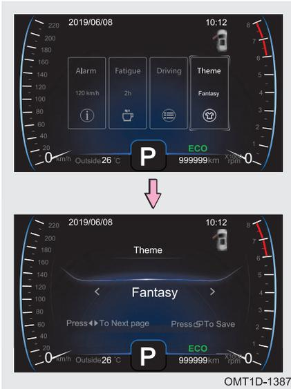
Шаг 1. При выведенном на дисплей экране настройки выберите функцию выбора темы оформления с помощью кнопки ◀ или ▶ на рулевом колесе, затем коротким нажатием кнопки ввода перейдите в режим выбора темы оформления.
