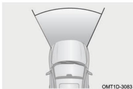
Условия срабатывания. Как правило, в случае фронтального столкновения подушка безопасности водителя, подушка безопасности переднего пассажира, подушка безопасности для защиты коленей водителя (для некоторых вариантов исполнения автомобиля) и подушка безопасности для защиты коленей переднего пассажира (для некоторых вариантов исполнения автомобиля) срабатывают, если замедление автомобиля превышает определенную величину.
