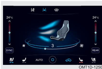
Обогреватели сидений работают при выключателе пуска двигателя, находящемся в положении ON. Выключатель управляет работой обогрева сиденья водителя, а выключатель — работой обогрева сиденья переднего пассажира. При первом нажатии на выключатель включается вторая ступень нагрева (загораются оба индикатора). При втором нажатии на выключатель включается первая ступень нагрева (загорается один индикатор). При третьем нажатии на выключатель обогреватель выключается.
