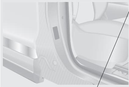
Табличка с данными автомобиля расположена на средней стойке кузова в проеме двери переднего пассажира, как показано на иллюстрации.
