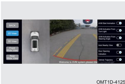
[AVM Start Animation] (главный экран монитора кругового обзора). Выберите данный пункт, чтобы перейти на главный экран. При первом включении монитора кругового обзора на дисплей выводится главный экран монитора кругового обзора.
