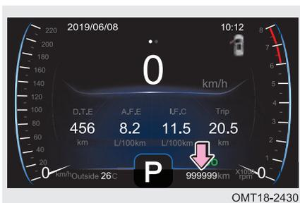
Отображается суммарный пробег автомобиля с начала его эксплуатации. Показания одометра могут быть в интервале от 0 до 999 999 км. При достижении 999 999 км показания одометра перестают изменяться.
