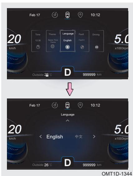
Шаг 1. При выведенном на дисплей экране настройки нажмите кнопку ◀ или ▶ на рулевом колесе, чтобы переключиться в режим выбора языка. Нажмите на нижнюю часть кнопки/коротко нажмите кнопку OK на рулевом колесе для для перехода на экран выбора языка.
