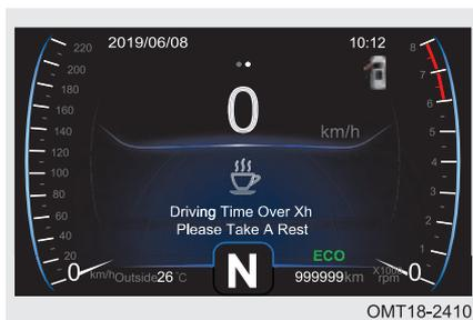
Когда длительность поездки превысит заданную величину, на информационном дисплее появится сообщение «Driving Time Over – h, Please Take A Rest» (Длительность поездки превысила – ч. Пожалуйста, отдохните). Одновременно включается звуковая сигнализация и загорается индикатор усталости водителя ☕, предлагая водителю отдохнуть.
