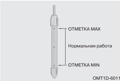
Положите ветошь под конец щупа, чтобы масло не капало на двигатель или кузов автомобиля.
