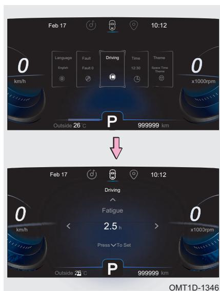
Шаг 1. При выведенном на дисплей экране настройки нажмите кнопку ◀ или ▶ на рулевом колесе, чтобы переключиться на экран информации о вождении автомобиля. Нажмите на нижнюю часть кнопки/коротко нажмите кнопку OK на рулевом колесе для для перехода на экран отображения информации о вождении автомобиля.
