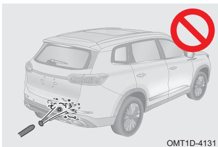
Использование установки высокого давления для мойки ультразвуковых датчиков, а также воздействие на них высоких внешних нагрузок может вывести датчики из строя. Не надавливайте на датчики и не подвергайте их ударной нагрузке. Это может нарушить работоспособность датчиков.
